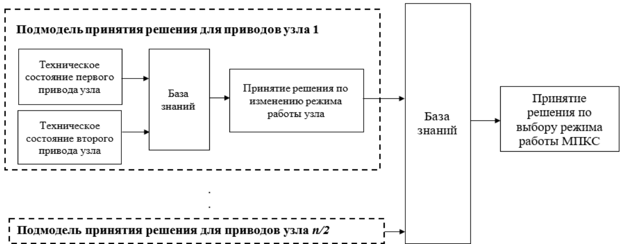
Рисунок 6 – Структура нечеткой модели принятия решения по выбору режима эксплуатации системы приводов МПКС со сходящимися кинематическими цепями
