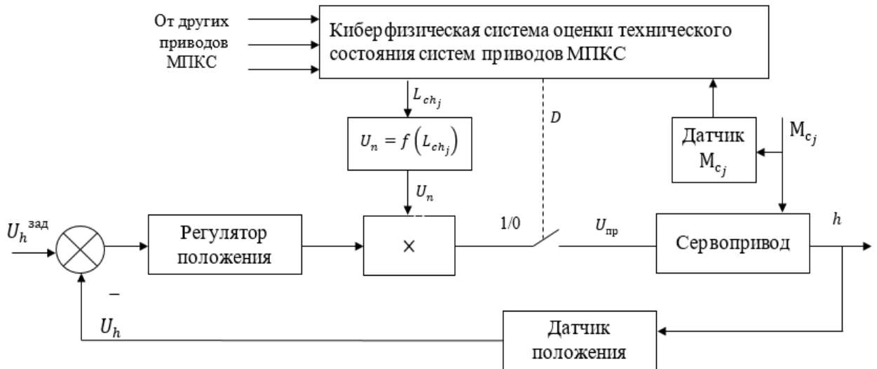
Рисунок 7 – Модернизированная локальная система управления приводом звена МПКС с коррекцией внешней нагрузки
