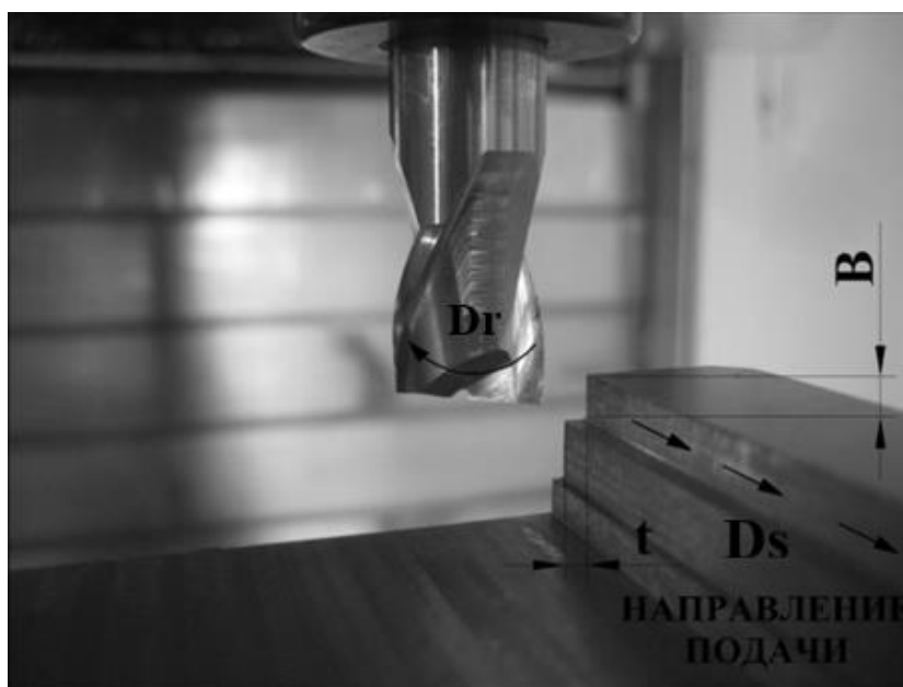
Рисунок 3.9 – Схема фрезерования уступа
