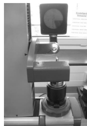
Рисунок 3.6 – Определение вылета инструмента
