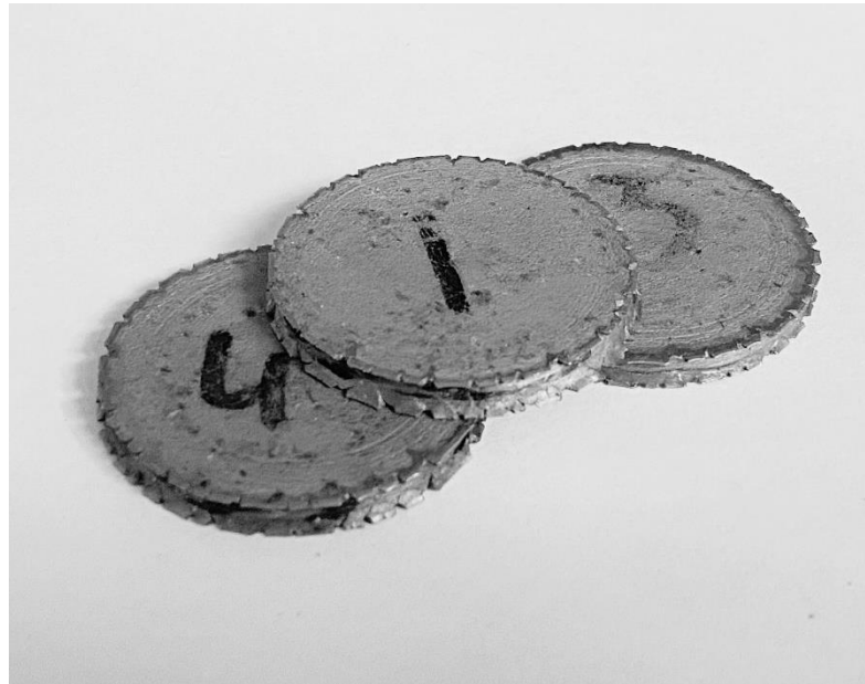
Рисунок 3.34 – Образцы после осадки
