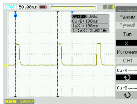
Рисунок 68 – Осциллограмма импульсов излучения на втором этапе опыта
