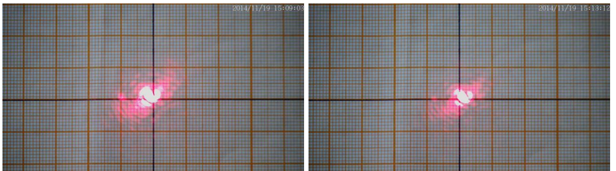
Рисунок Д.20 – Второй излучатель до и после юстировки (седьмой опыт)
