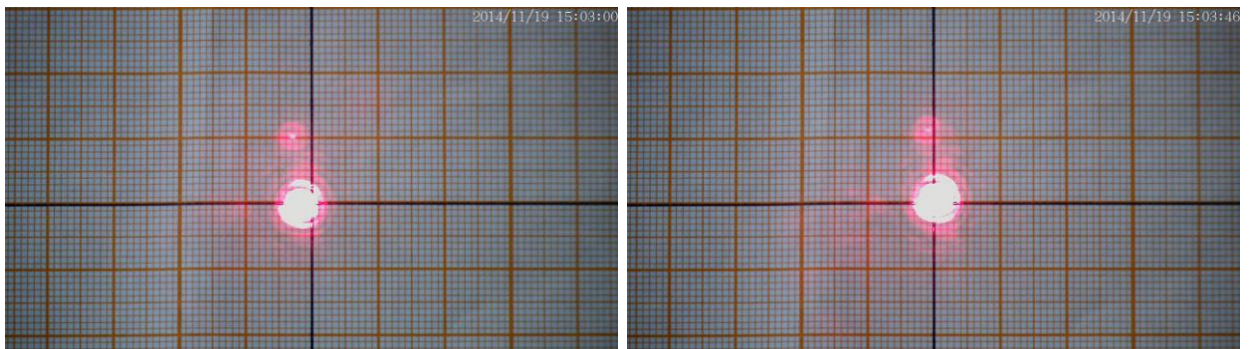
Рисунок Д.18 – Третий излучатель до и после юстировки (шестой опыт)
