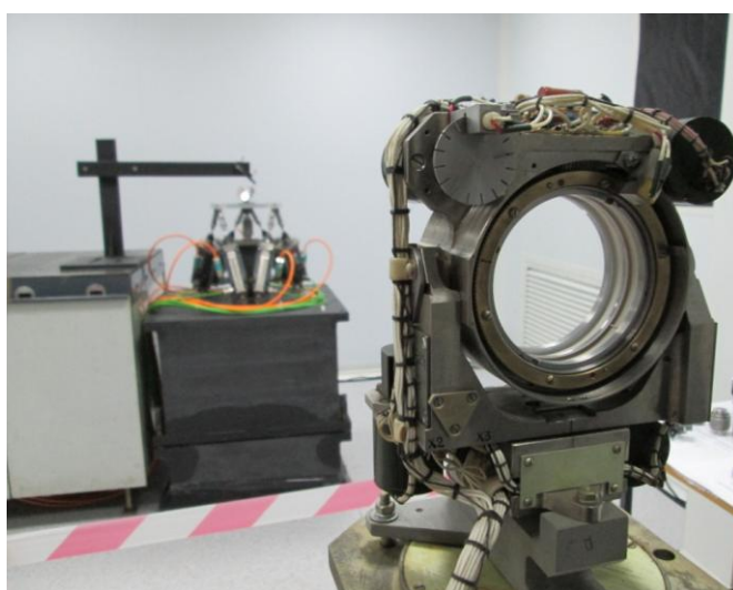
Рисунок 58 – Вращающиеся оптические клинья в оправе
