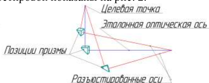
Рис. 2. – Позиции призмы при компенсации разъюстировок
