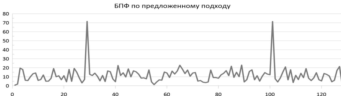
Рисунок 4.10. Результаты моделирования работы БПФ с заменой операций умножения на операции сдвига
