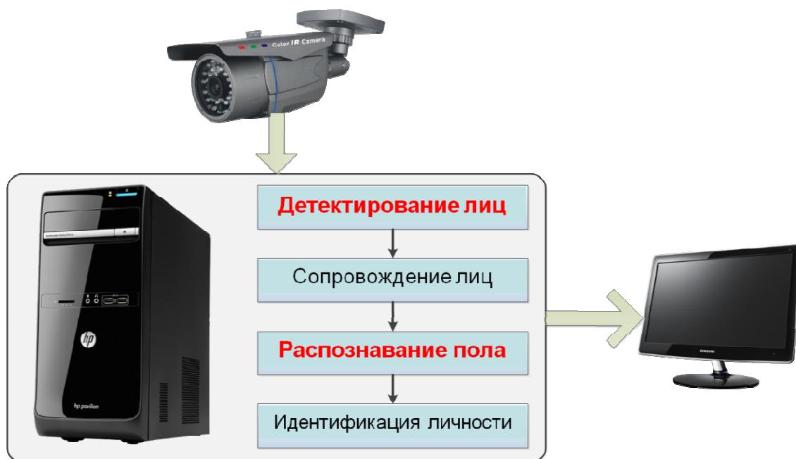
Рис 1.1. Схема биометрической идентификации на основе анализа области лица на изображении
