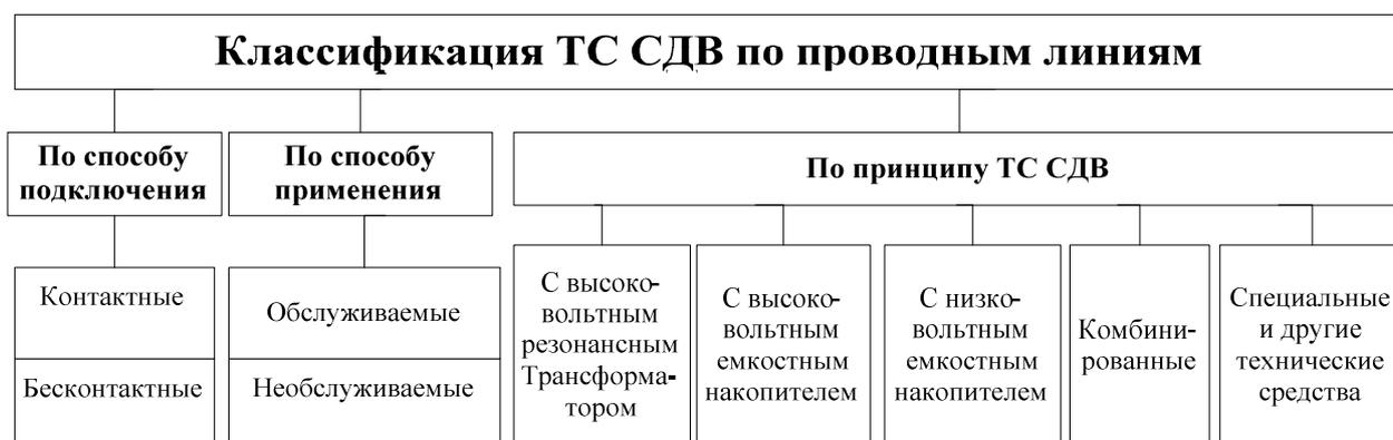
Рис.2. Классификация ТС СДВ по проводным линиям
