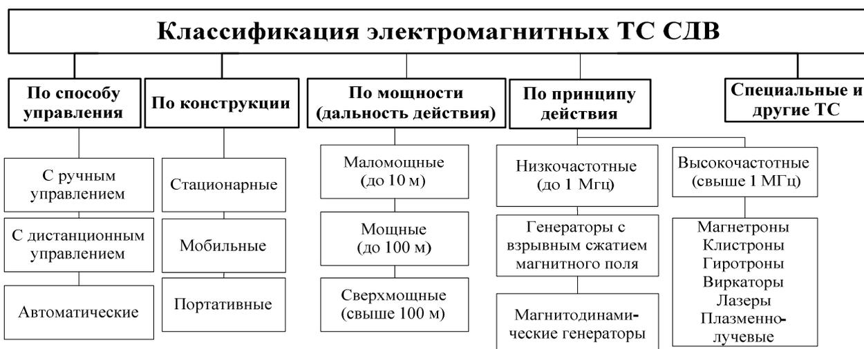
Рис.3. Классификация ТС СДВ по эфиру (электромагнитные ТС СДВ)
