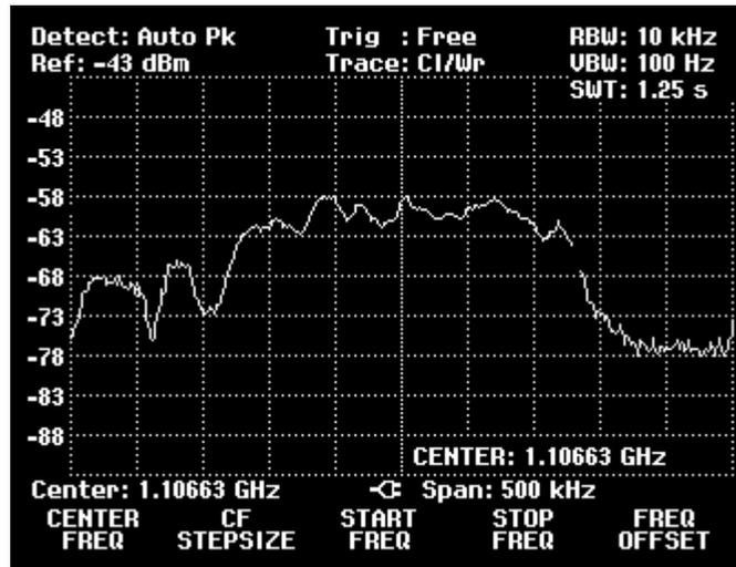
Рисунок 3.9 —  $(C+N)/N$  головная станция антенна 9.3 м
