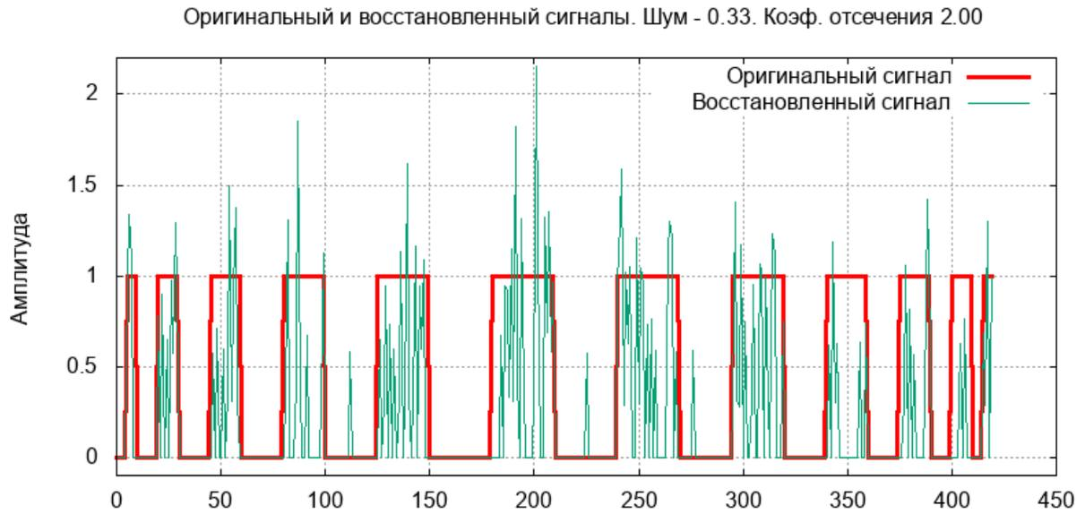
Рисунок 4.31 — Исходный и восстановленные сигналы при амплитуде шума 0.33 и коэффициенте отсеечения 2.0
