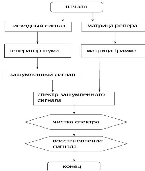
Рисунок 4.4 — Функциональная блок-схема алгоритма восстановления амплитуды зашумленного сигнала.
