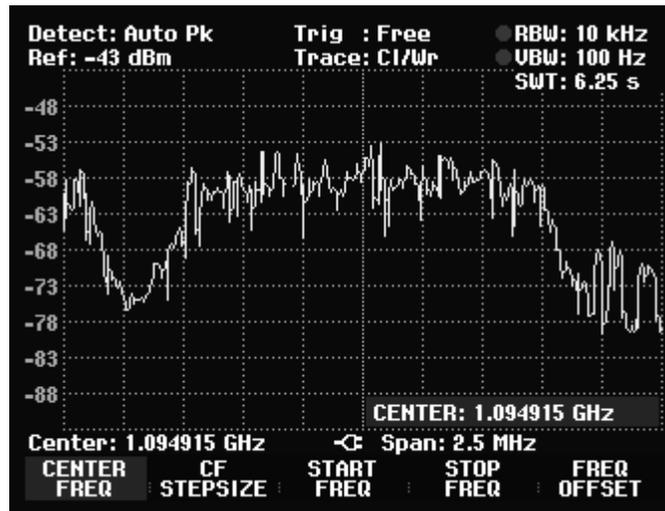
Рисунок 3.10 —  $(C+N)/N$  головная станция антенна 11 м
