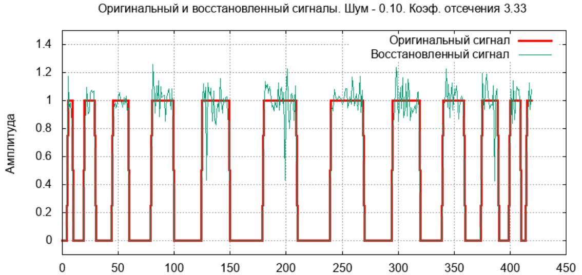
Рисунок 4.20 — Исходный и восстановленные сигналы при амплитуде шума 0.10 и коэффициенте отсеечения 3.33
