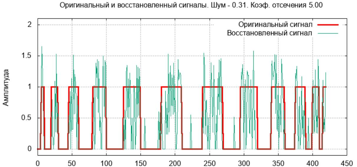
Рисунок 4.29 — Исходный и восстановленные сигналы при амплитуде шума 0.31 и коэффициенте отсечения 5.00
